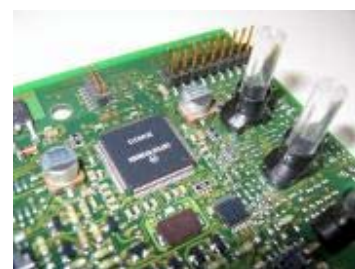
Zdjęcie w świetle dziennym: Zmontowana płytką pokryta ELPEGUARD® SL 1301 ECO-FLZ
