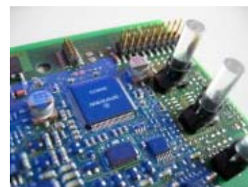
Zdjęcie pod światłem UV (czarne światło): zmontowana płytką pokryta ELPEGUARD® SL 1301 ECO-FLZ
